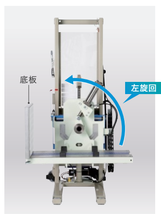
「左側」に底板を取り付け
