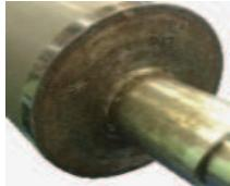
今まで苦労していた、シリンダに厚く堆積したインキ等を洗浄液の溶解力と超音波洗浄機併用により効果的な洗浄可能
