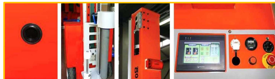
①超音波センサー ②落下防止装置 ③走行警告灯 ④便利なモニター
